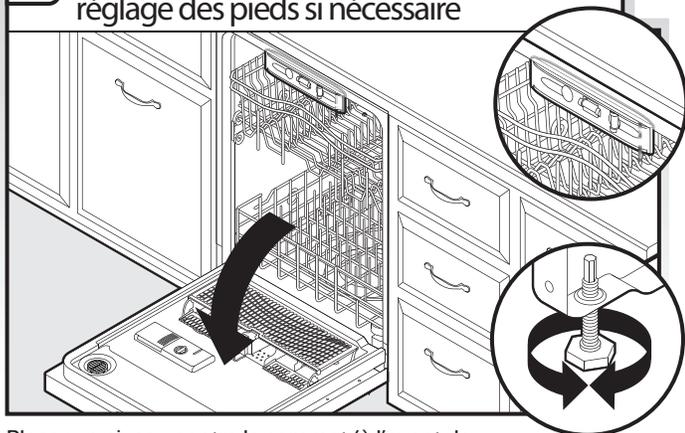
Placer un niveau contre le sommet/à l'avant de l'ouverture de la cuve. Vérifier l'aplomb transversal du lave-vaisselle. Si l'aplomb du lave-vaisselle n'est pas correct, ajuster le déploiement (abaissement/soulèvement) des pieds avant pour établir le bon aplomb du lave-vaisselle.
